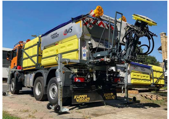
Der im Winterdienst eingesetzte Salzstreuer von Küpper-Weisser kann mit Sole und mit Salz betrieben werden (unten). Zusätzlich verfügt der 3-Achser über einen Hiab-Ladekran am Heck (oben).
