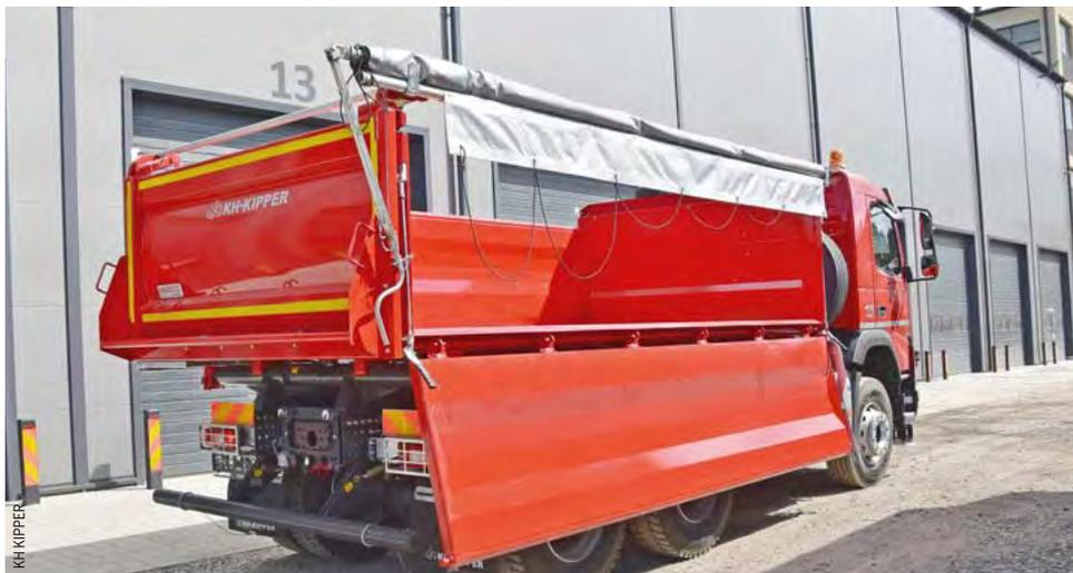
Bei abgeklappter rechter Bordwand kann man mit dem Gabelstapler an den Kipper heranfahren und ihn mit Paletten beladen. Die Rollplane ist vom Boden aus bedienbar.
